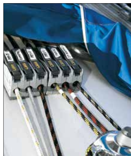
Släpp på storfallet till i förväg markerad revpunkt.
