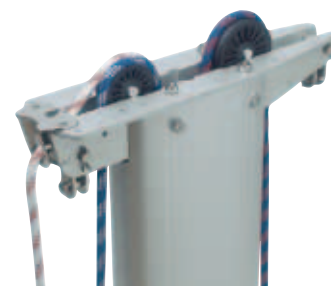
Trissorna demonteras utan att man behöver masta av och ta bort toppbeslaget.
