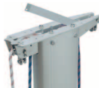
Mellanplåten låser trissorna och styr samtidigt spinnakerfallet.
