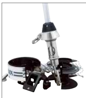
Ta bort linnehållare, linledare, lina och trumhalvor.
