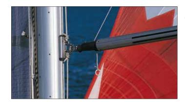
Le système de réglage de la hauteur du chariot de tangon assure des manœuvres de spinnaker sans effort et permet à l'équipage de régler le spinnaker de façon parfaite.
