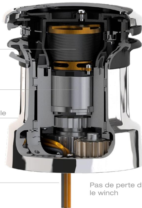
Le E40i est alimenté par le système Seldén SEL-Bus et le bloc alimentation (PSU) qui convertit le 12/24V en 42V – Cela permet plus d'efficacité pour un produit compact. Le winch E40i et le mât enrouleur électrique Seldén se connectent pour créer le système révolutionnaire Seldén du Mât enrouleur synchronisé (SMF). Appuyez sur un bouton et le winch E40i réglera automatiquement la tension de la bordure pendant que votre mât enrouleur enroule ou déroule la grand voile.
