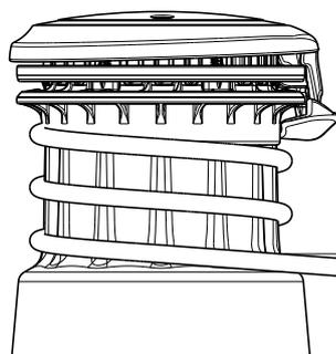
*Le winch E40i est un winch pour toutes applications, pour cordages de diamètres 8 à 14 avec angle d'entrée entre 5° et 10°*
