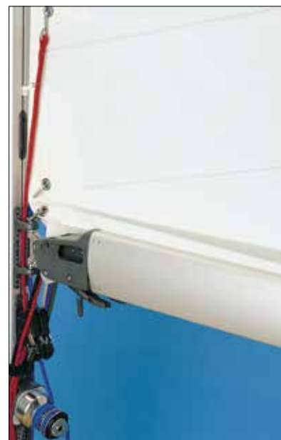
Prise de ris avec crochets en S sur bosse.
