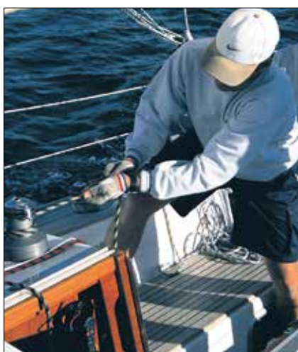
Etarker la bosse de ris jusqu'à la marque faite sur la bosse.
