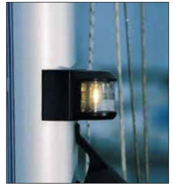
Motorgångsljus Finns i två versioner för båtar mindre än 12 m och för båtar mellan 12 m och 20 m, i svart komposit eller i rostfritt stål.
