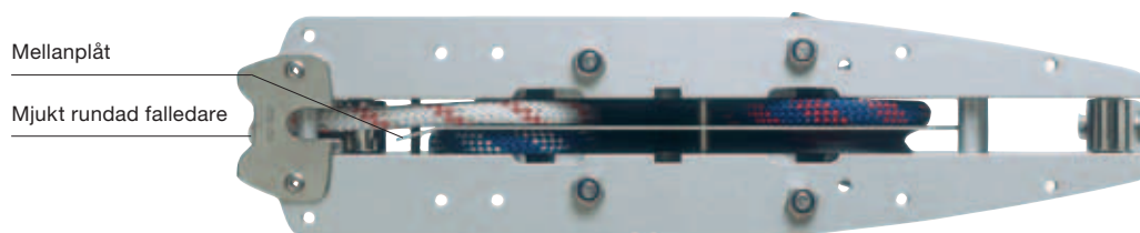
Toppbeslag för C211-C301 och F212-F406. Toppbeslaget har en mjukt rundad fallstyrning för topphissad spinnaker eller gennaker. Den lätt vinklade mellanplåten fungerar också som styrning av fallet in på trissan.
