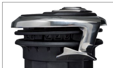
La gorge du self tailing n'a pas la forme biseautée habituelle. C'est une cavité arrondie encerclant le cordage. Un disque à ressort exerce une légère pression qui permet de garder le cordage en place. Le bras de chargement est en acier inoxydable poli.
