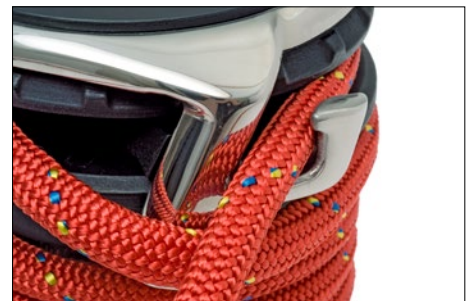
Doigt de décrochage doux et bien arrondi. L'écoute est libérée rapidement au virement de bord.
