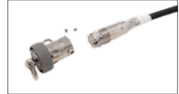
Meta el cable por dentro del terminal y doble el alma sobre las cu3as. Meta las cu3as en el terminal.
