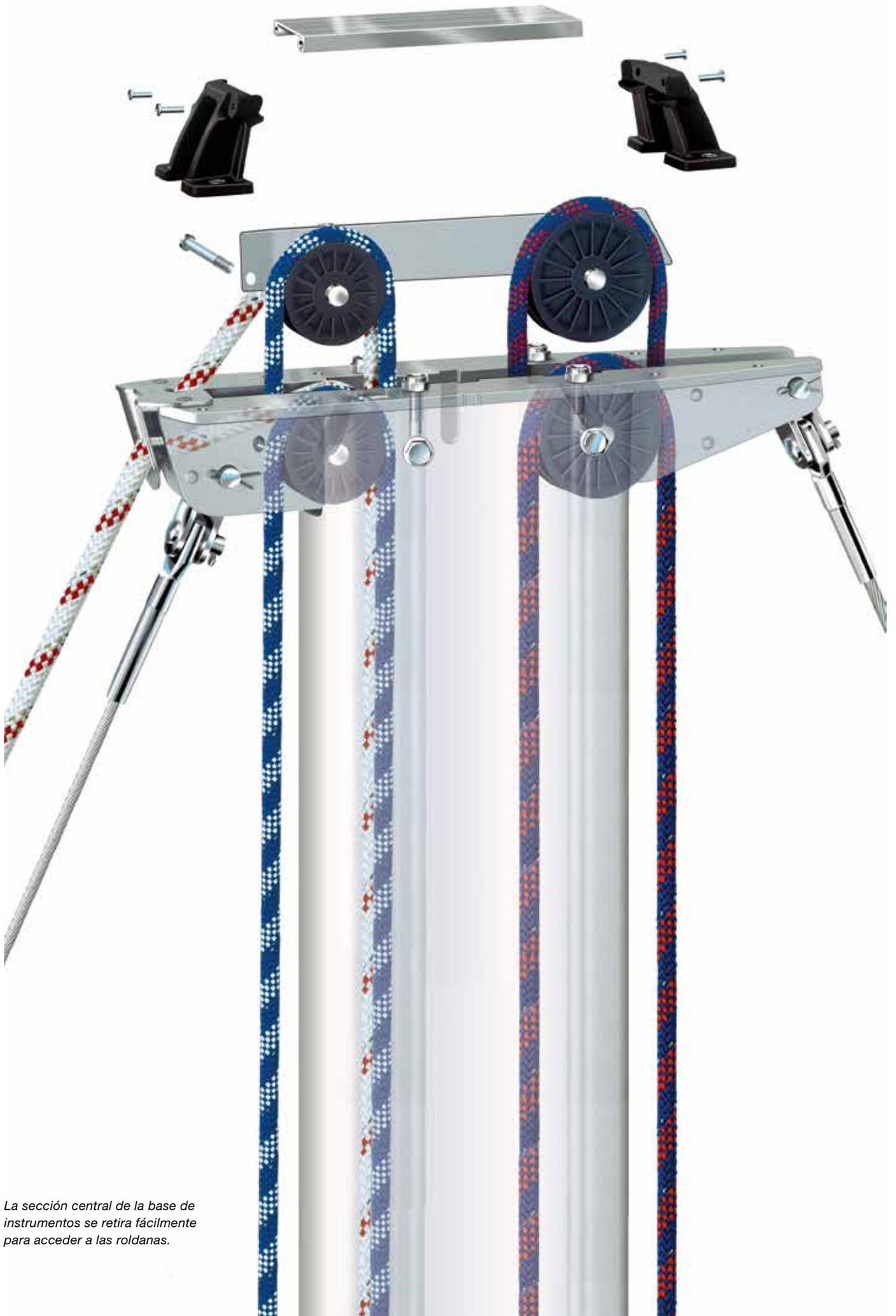
*La sección central de la base de instrumentos se retira fácilmente para acceder a las roldanas.*
