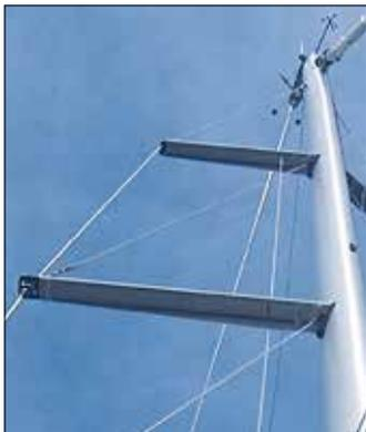
Crucetas T Seldén para Secciones-C y secciones-F.
