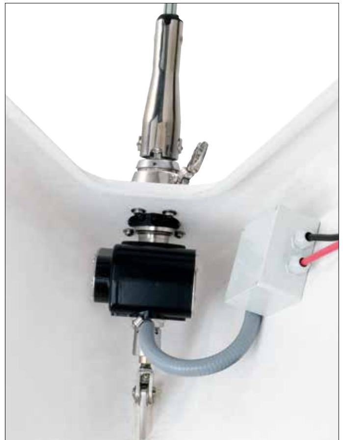
Installation d'un Furlex 200E. Le boîtier de connexion est étanche.
