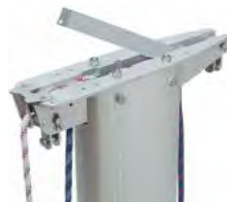
Le séparateur bloque les réas et guide aussi la drisse de spinnaker.
