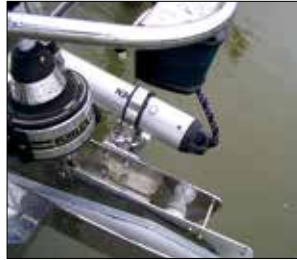
Seitlich montierter Führungsring
