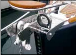
Im Ankerbeslag integrierter Führungsring.
