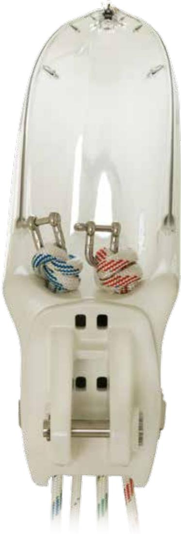
Perfil conicó bellamente formado. La imagen muestra el terminal del extremo interior integrado con las roldanas ocultas para la toma de rizos automáticos, carril integrado para la funda de la vela y cáncamos para los lazy jacks.
