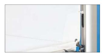
Los patines se introducen por la entrada de vela accionada por un muelle. Al tomar rizos, los patines pasan por la entrada cerrada, hasta la botavara, manteniendo la vela en su sitio y -facilitando la toma de rizos de forma rápida y segura. Cuando se retira la parte accionada por muelle de la entrada, ésta se puede utilizar fácilmente con una relinga de cabo.
