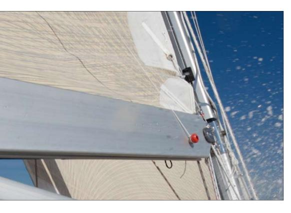
La entrada de vela diseñada para los carros MDS o para patines convencionales. Cuando se utiliza con carros MDS, para colocar o retirar los carros basta con extraer la entrada. Con patines convencionales, utilice la sección media de la entrada accionada por un muelle.
