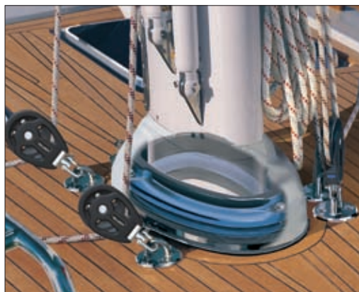
I mastens däcksgenomföring ingår en kraftig O-ring som pressas ihop vertikalt mellan två "däcksringar", där den undre ringen sitter fast monterad i däck. Enkelt att montera samtidigt som den ger masten erforderlig rörlighet i alla riktningar.
