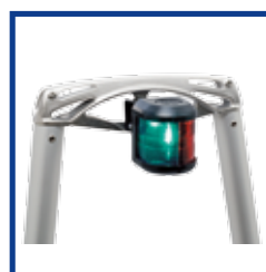
Hanfoten är säkrad i ett spår i hanfotsbeslaget. Förberett för montering av lanternan.
