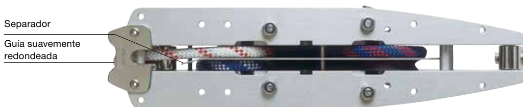
Tope de palo para aparejo a tope C211-C301 y F212-F406. El tope de palo está provisto de una guía ligeramente redondeada para spinnaker y gennaker aparejados a tope. El separador presenta un pequeño ángulo en su extremo delantero para guiar la driza a la roldana.
