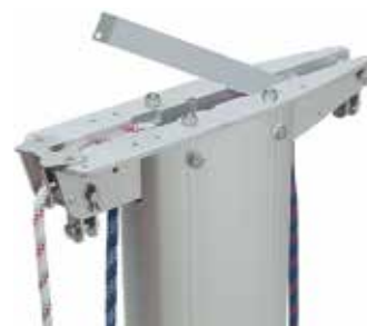
El separador sujeta las roldanas y, además, controla la driza del spinnaker.
