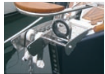
Führungsring mit Montagebeschlag an Ankerhalterung.
